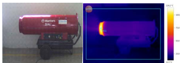
Figura 1. Imagem real e termográfica do sistema de aquecimento.
