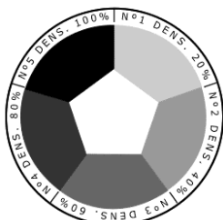
Fig. 1. Escala Gráfica de Ringelmann.
