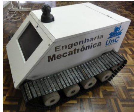
Fig. 1. Tanque-Robô com câmera acoplada e monitor.
